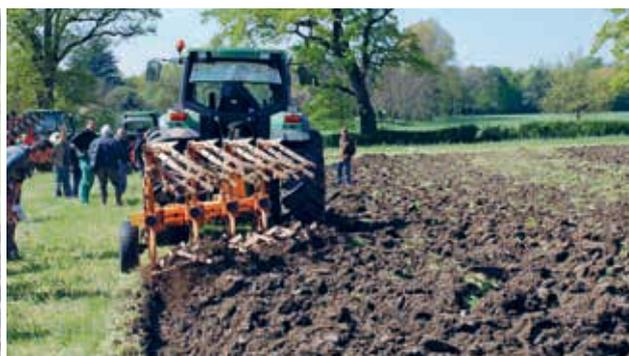
Une charrue pour un labour superficiel de la marque espagnole Escudero (à gauche) et une charrue classique travaillant à profondeur réduite grâce une béquille à roue.
