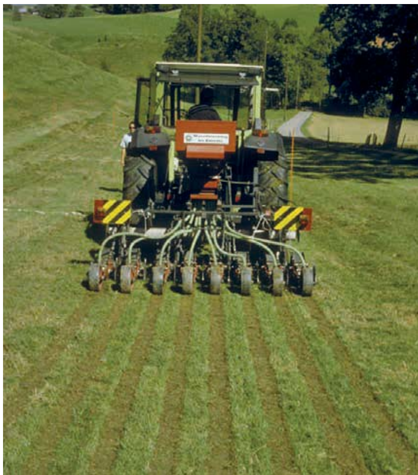
Le Vakutec Slotter fraise la prairie et dépose la semence avec un semoir pneumatique. Un rouleau à pneus tasse ensuite la bande fraisée et les graines semées.
