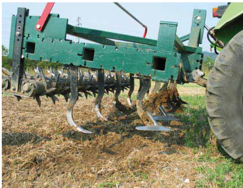
L'essai de longue durée de Frick utilise un chisèle de la marque Wenz, de Schwanau en Allemagne.
