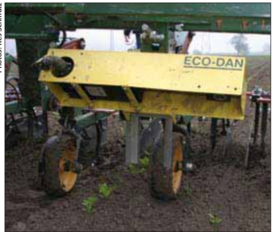
Les caméras installées dans le caisson jaune sont les yeux de la sarceuse.
